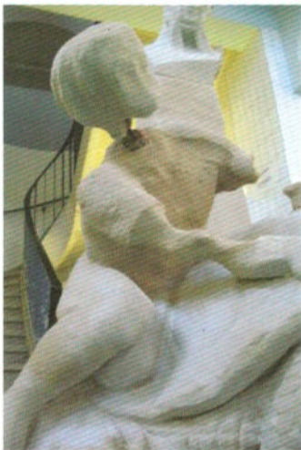
Die durch eindringendes Chlorwasser stark zerfressenen Skulpturen mussten aus Sicherheitsgründen entfernt werden.
