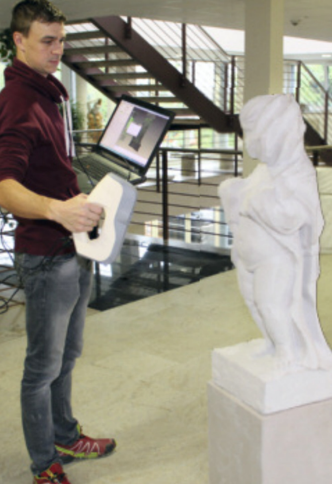
Bild 1: Michael Merz von Probst Stein & Design scannt in 10 min eine Putte ein. Fotos: Dieter Gerlach, Probst GmbH
